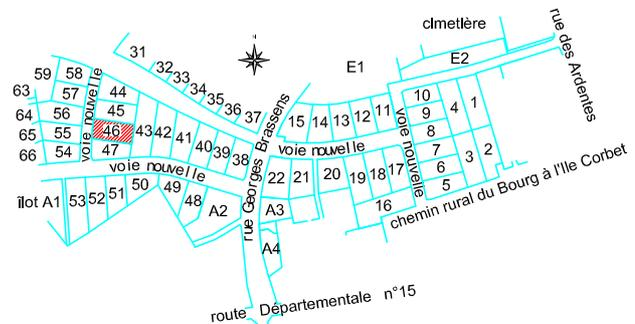
Nota: Tracé des accès imposés et des zones non constructibles à partir du fichier informatique (DCE-0-JCL-86005-VOUNEUIL-Zac des tuilas) transmis le 29/10/2010 par le B.E.T. ASTEC SUD
